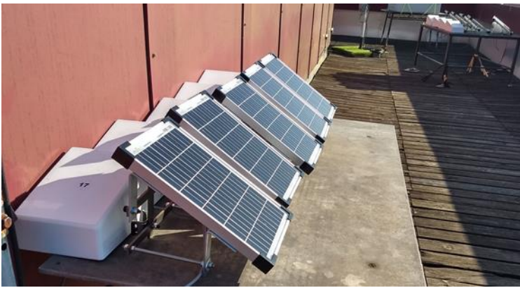
Abbildung 1: Dauertest unserer IoT-Sensorboxen zur Messung der Luftqualität
