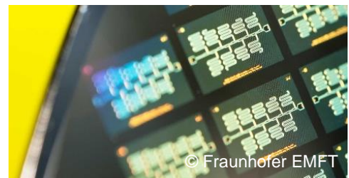
Resonatoren für supraleitende Qubits auf 200 mm Wafer mit Nb-Beschichtung
