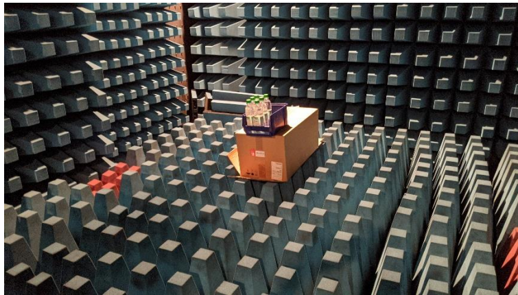
Abb. 3: Leistungsmessung der modulierten Tag-Antwort in einer EMV-Messkammer
